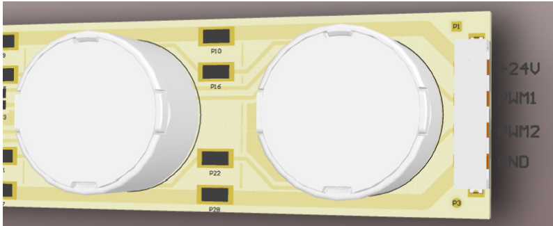
Abbildung 2: Anschlussbelegung der Buchse auf dem LED-Modul
